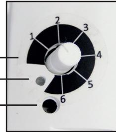
Es ist ratsam, zu Beginn die Sensibilitätseinstellung auf Stufe 1 zu belassen. Die LED (2) leuchtet 2-mal kurz hintereinander alle 3 Sekunden auf. Die 365pro+Hybrid Mobil verfügt über eine Drei-Stufen-Infraschall-Detektion. Über den innenliegenden Druckknopf (1) kann die jeweilige Stufe ausgewählt werden.
