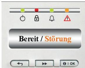
Einer **Störungsmeldung** sollte immer auf den Grund gegangen werden, da evtl. ein Netzstecker oder die Akku Batterie nicht in Ordnung sein könnte und die 365pro+Hybrid Mobil unter Umständen nicht wie erwartet arbeiten kann. Bei einer Störung piept die 365pro+Hybrid Mobil jede Minute 3x kurz hintereinander, gleichzeitig leuchtet eine gelbe LED im Display auf, bis die Störung behoben ist.
