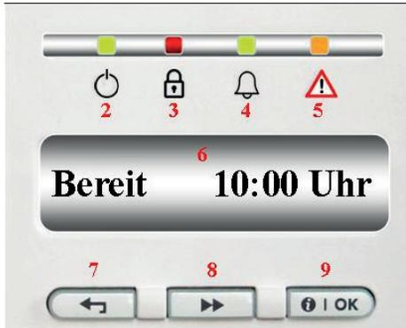
2. Spannung (Grün): der Netzstecker ist angeschlossen.
